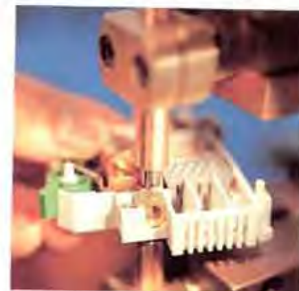
Nur mit Gleichstrom lassen sich Draht und Klemme des bereits bestückten Schutzschalters verbinden
