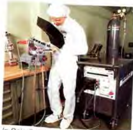
In Reinräumen ist für unvermeidliche Rohrschweißarbeiten das Orbitalverfahren von Polysoude geeignet
