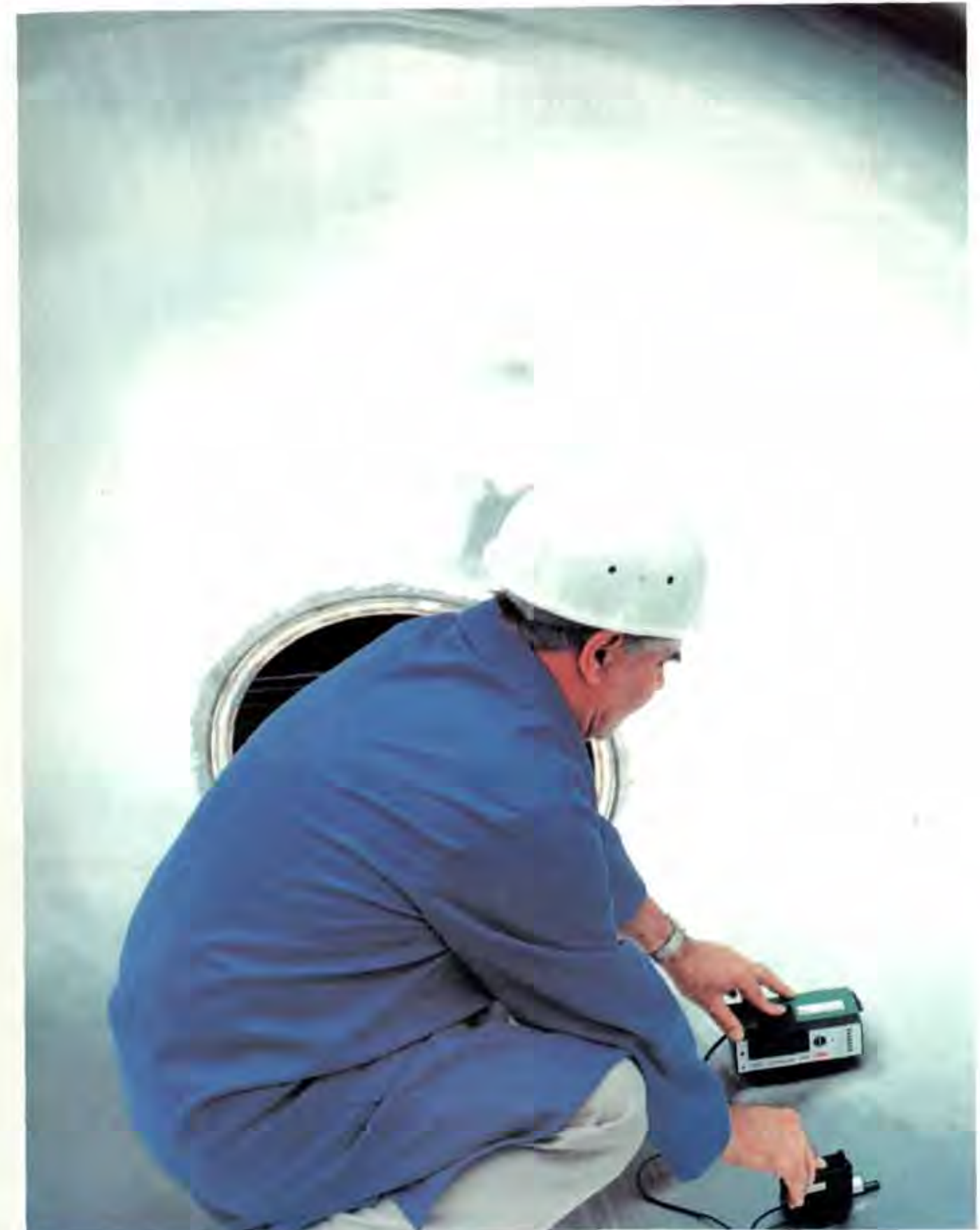
Kontrolle der Oberflächenrauigkeit im geschliffenen Boden eines Innenbehälters für ultrareine Gase
