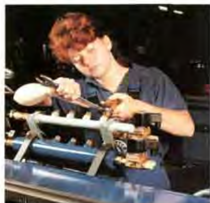
Praxisgerechte Ausbildung: die Montage der Armaturen für die Gasversorgung einer Brennschneidmaschine
