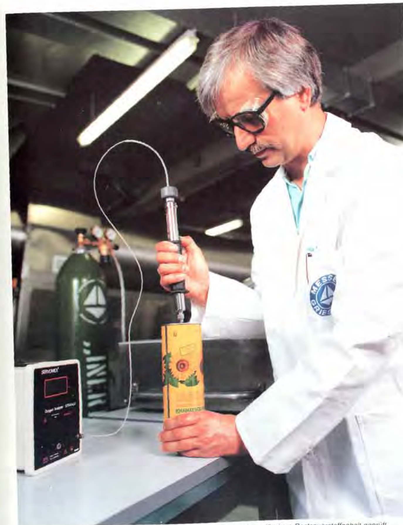
Unter Schutzgas verpackte Lebensmittel werden in Stichproben auf den zulässigen Restsauerstoffgehalt geprüft
