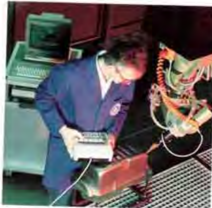
Ford setzt auf Laser: Für Ausschnitte an Ölwanne wird die Kontur mit dem Teachkopf programmiert
