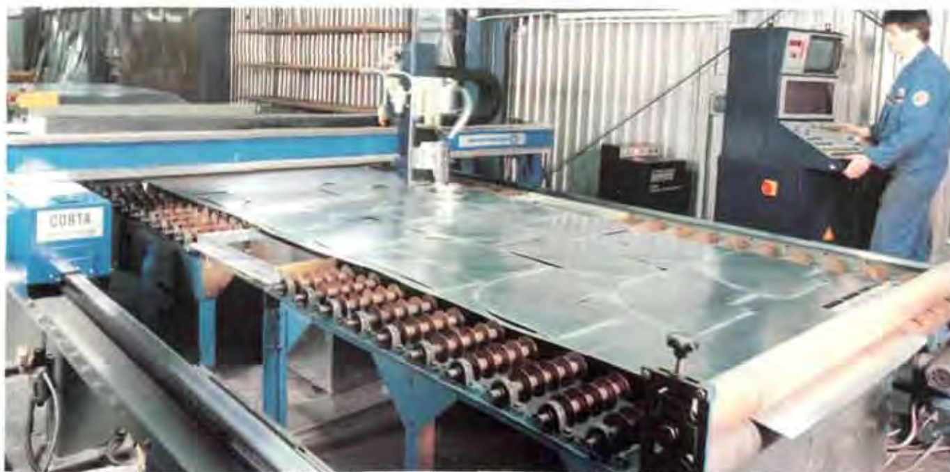
Kaum sichtbar, aber wirkungsvoll wird der Rauch unterhalb des Schneidtisches der Brennschneidmaschine abgesaugt
