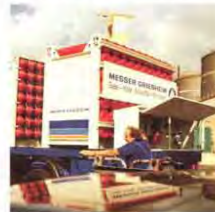
Teil unseres Versorgungskonzepts sind Spezialfahrzeuge für gasförmigen (Bild) und flüssigen Wasserstoff
