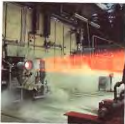
Brennkammerversuche für Raketentriebwerke mit Wasserstoff
