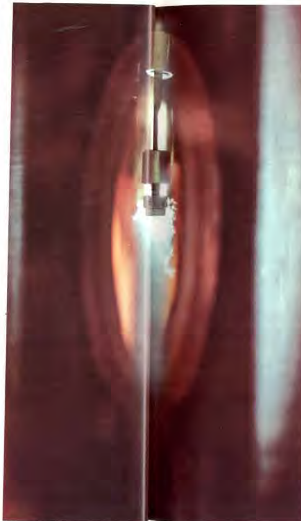
Wasserstoff-Matsch, ein Gemisch aus festem und flüssigem Wasserstoff
