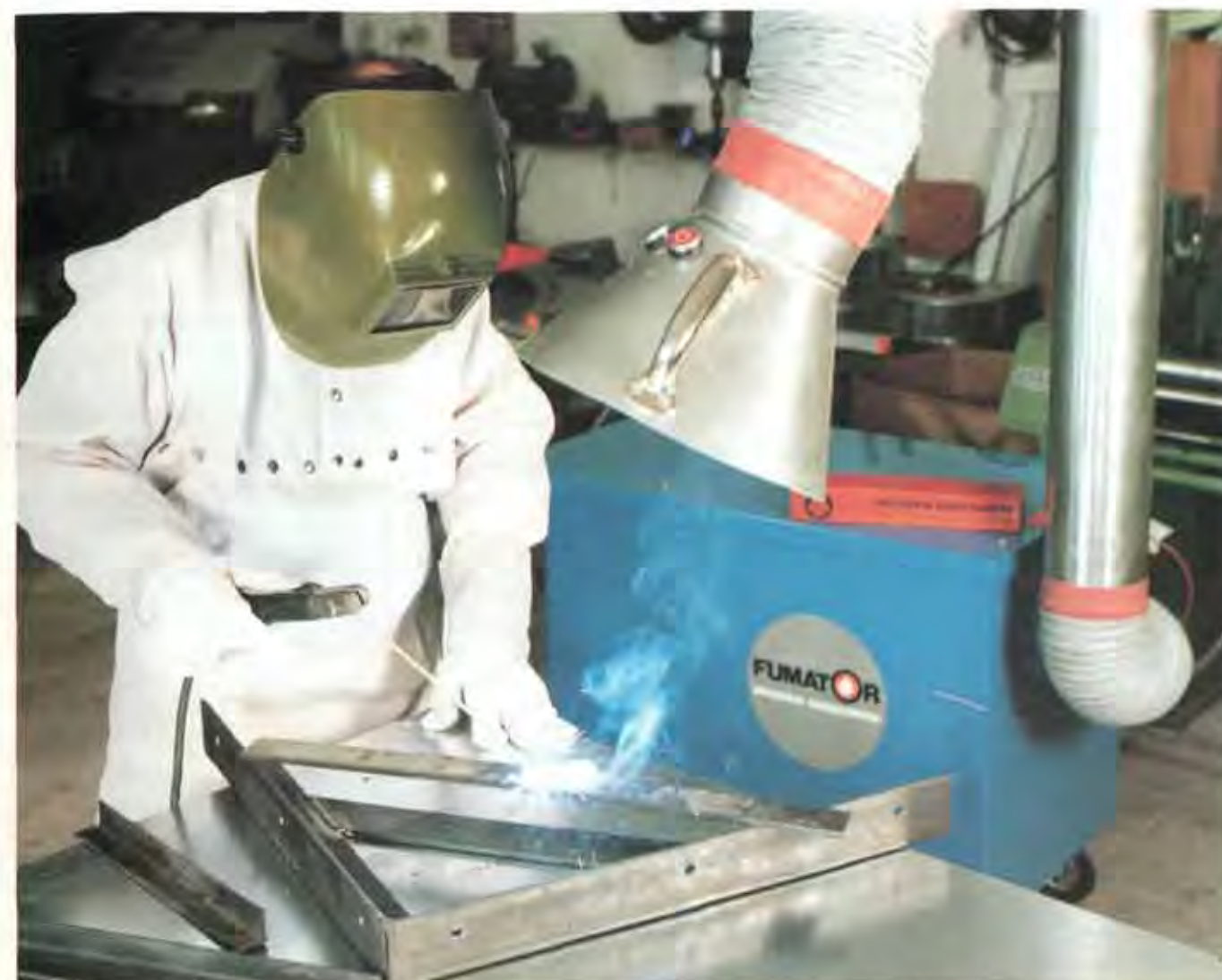
Neue Schutzhelme und Filteranlagen zum Absaugen des Schweißrauchs erhöhen die Sicherheit am Arbeitsplatz
