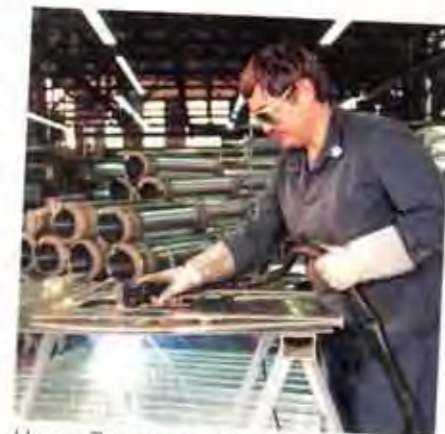
Unser Programm für das Plasmaschneiden reicht vom Handgerät (unten) bis zur CNC-Maschine (oben)
