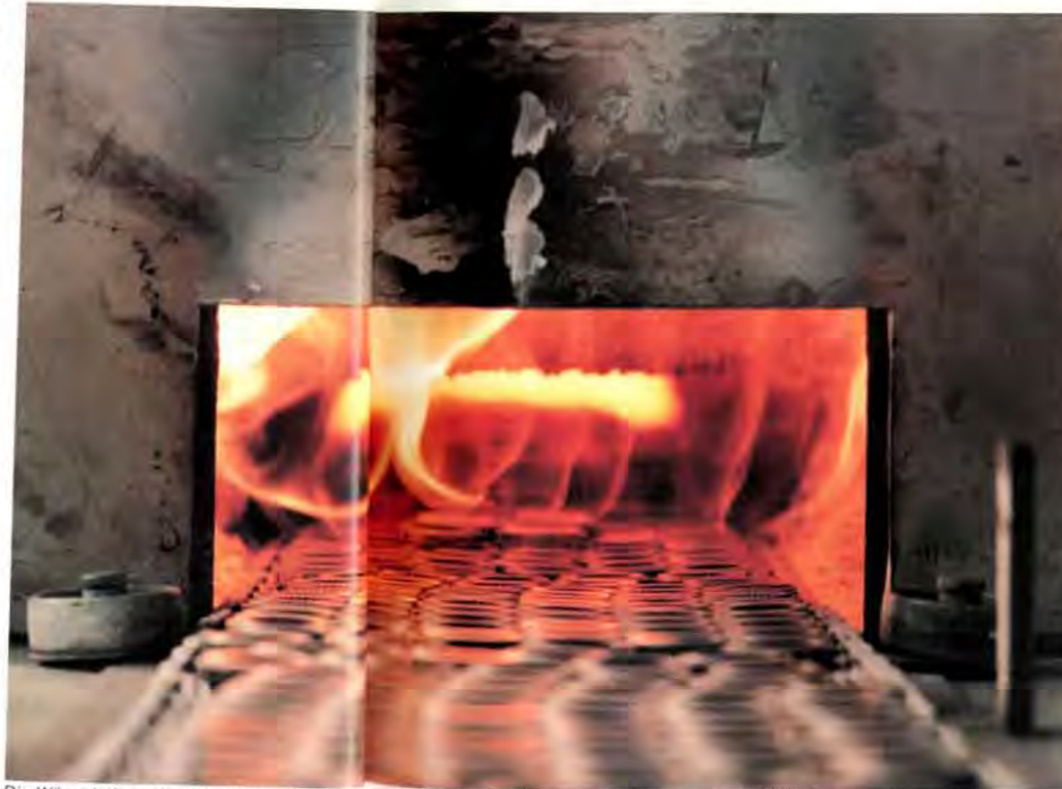
Zahnradern erfolgt unter Zugabe eines Stickstoff/Wasserstoff-Gemischs
