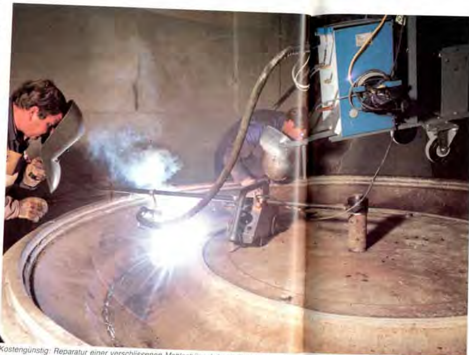
Unersetzlich: Sonderstabelektroden für hochwertige Verbindungen nichtrostender Stähle im Behälterbau
