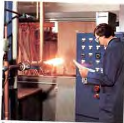
Praxistest: Sauerstoff-Brenner zur Erhöhung der Ofentemperatur auf unserem Prüfstand
