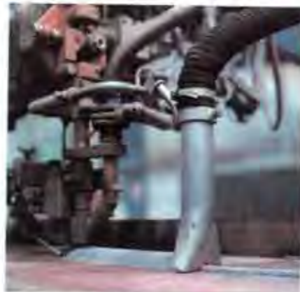
UP-Technik: Die Kombination aus Draht und Pulver bürgt für die Qualität der Schweißverbindung
