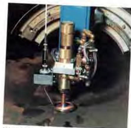
Werkzeuge zum Pulvermarkieren von Konstruktionsteilen ergänzen die Brenneraggregate
