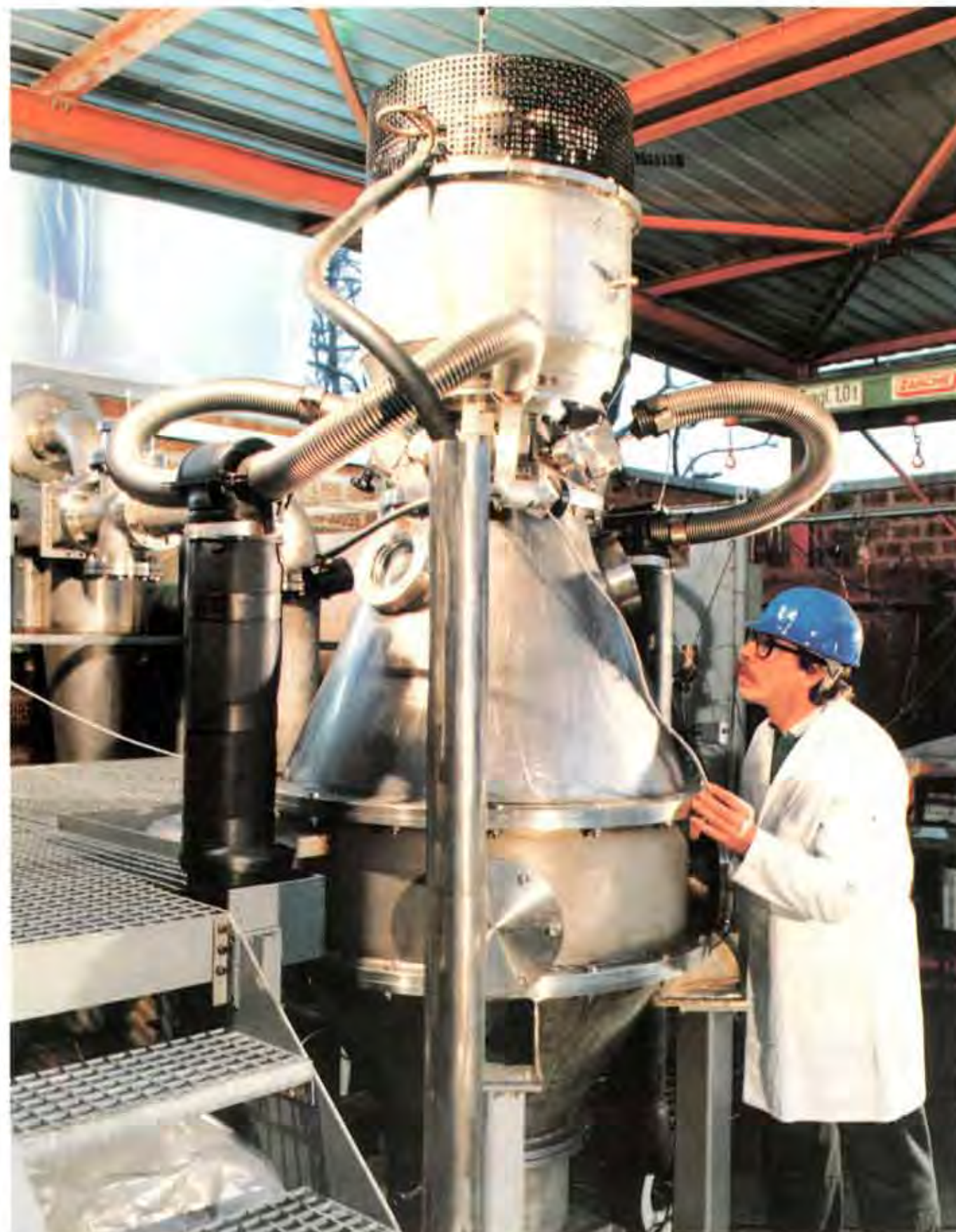
Gemeinsames Projekt mit der Leybold AG und der Universität Erlangen: das Zerstäuben schmelzflüssiger Metalle
