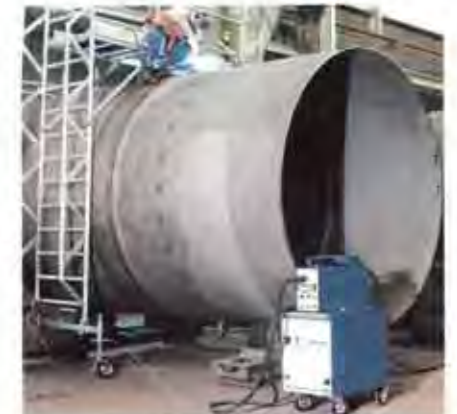
Das neue MIG/MAG-Schweißgerät reguliert Schweißspannung und Drahtvorschub beim Schweißen
