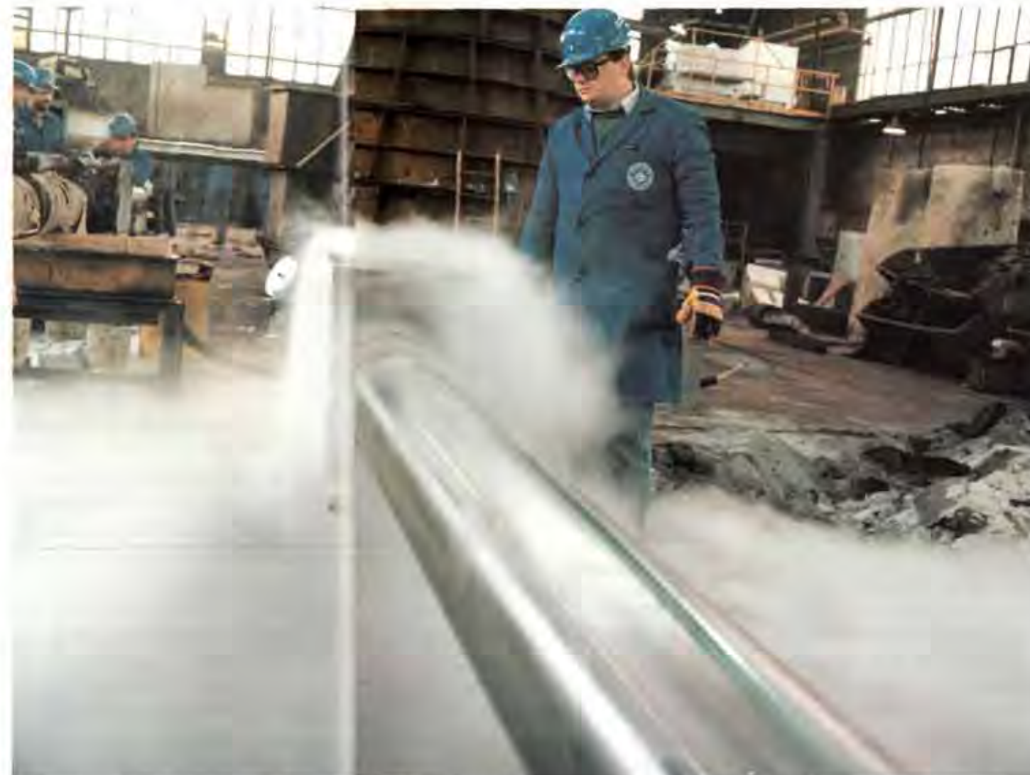
Kaltgedehnt: Stahlwellen schrumpfen in
